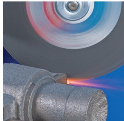
Наилучший результат достигается при работе с пневматическими машинами турбинного типа и мощными высокочастотными и электрическими угловыми шлифмашинами.
