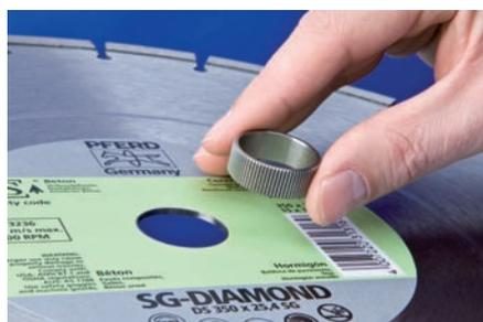
Переходное кольцо для алмазных шлиф.-отрезных кругов с диаметром отверстия  $\varnothing$  25,4 мм для применения с приводными шпинделями  $\varnothing$  22,23 мм.
